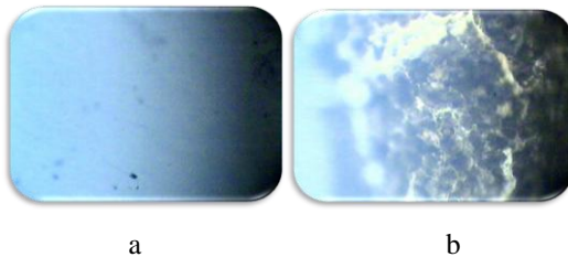
GAMBAR 10. Permukaan HDPE sebelum (a) dan sesudah (b) dilapisi \text{TiO}_2 di bawah mikroskop dengan perbesaran 10x [6].
