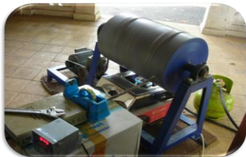
GAMBAR 3. Rangkaian alat pelapisan permukaan butiran polimer menggunakan cylinder milling [6].
