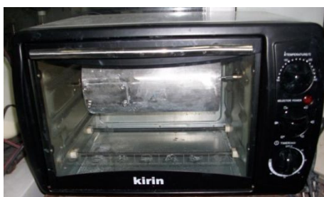
GAMBAR 1. Oven listrik rumah tangga dengan pengatur temperatur dan waktu dilengkapi dengan wadah pengaduk berbentuk silinder yang dapat berputar di bagian tengah oven.
