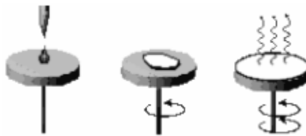
Gambar. 26. Tahapan proses pelapisan spin: pengendapan sol, spin up, spin off dan gelas dengan penguapan pelarut.
