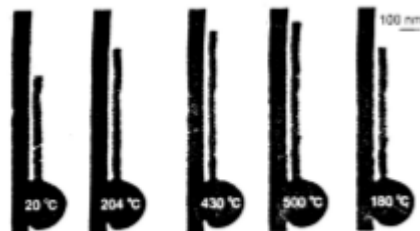
Ara. 102. Thermometer pada dasar MgO nanotube, dibuat di NIMS, Jepang.
