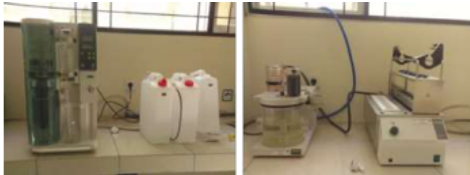
Gambar 3.6 Rangkaian alat analisis kandungan protein
