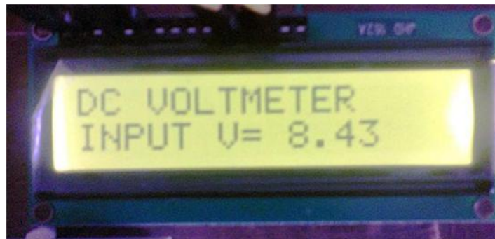
Gambar 6. Layar Tampilan Voltmeter Digital Arduino
