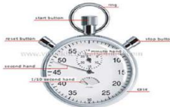
Gambar 4. Bagian Bagian Stopwatch Analog.
