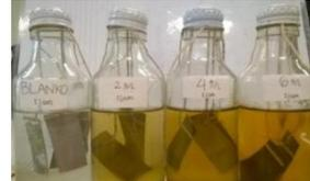
**Gambar 16.** Perendaman Besi dalam Media Korosi HCl 1M
