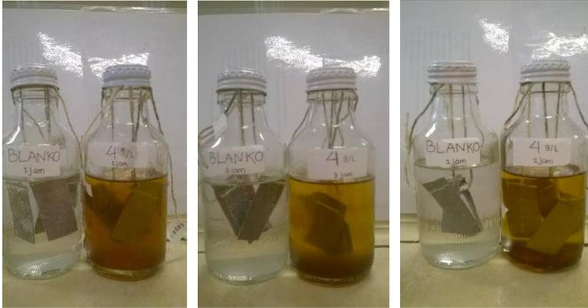
**Gambar 19.** Perendaman besi dalam media korosif tanpa dan dengan penambahan inhibitor
