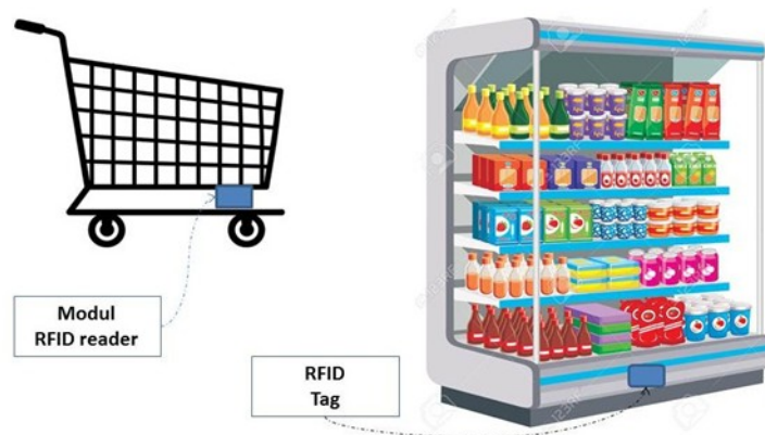
Gambar 3. Posisi Pemasangan Perangkat RFID
